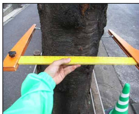
②ボルトからボルトの長さを測定
