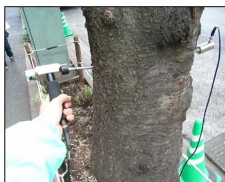
④センサーを設置しセンサーの反対側のボルトをハンマーで打つ
